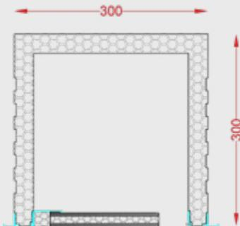
Cassonetti con ispezione a tampone con chiusura a incastro. Realizzato in EPS grafite, con celino in fibrocemento e XPS per maggior resistenza e isolamento termico.
